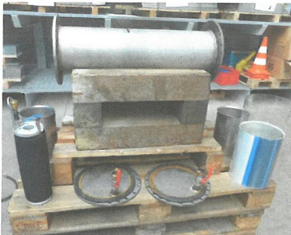
Bild 2: geschlitztes Stahlrohr DN 300 mit Verschlussdeckeln, Packer, Linerendmanschetten
