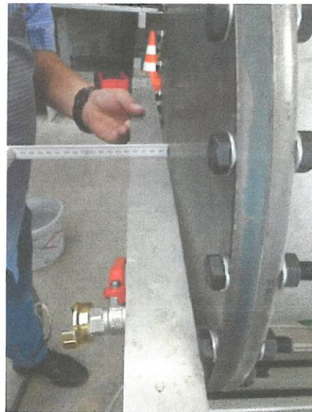
Bild 9: Messung der Deckelverformung
