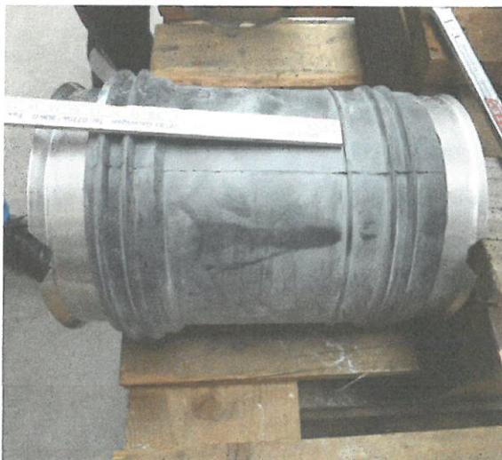
Bild 4: Quick-Lock Linerendmanschette mit EPDM-Dichtung, Rückschnitt des Liners um ca. 14 cm
