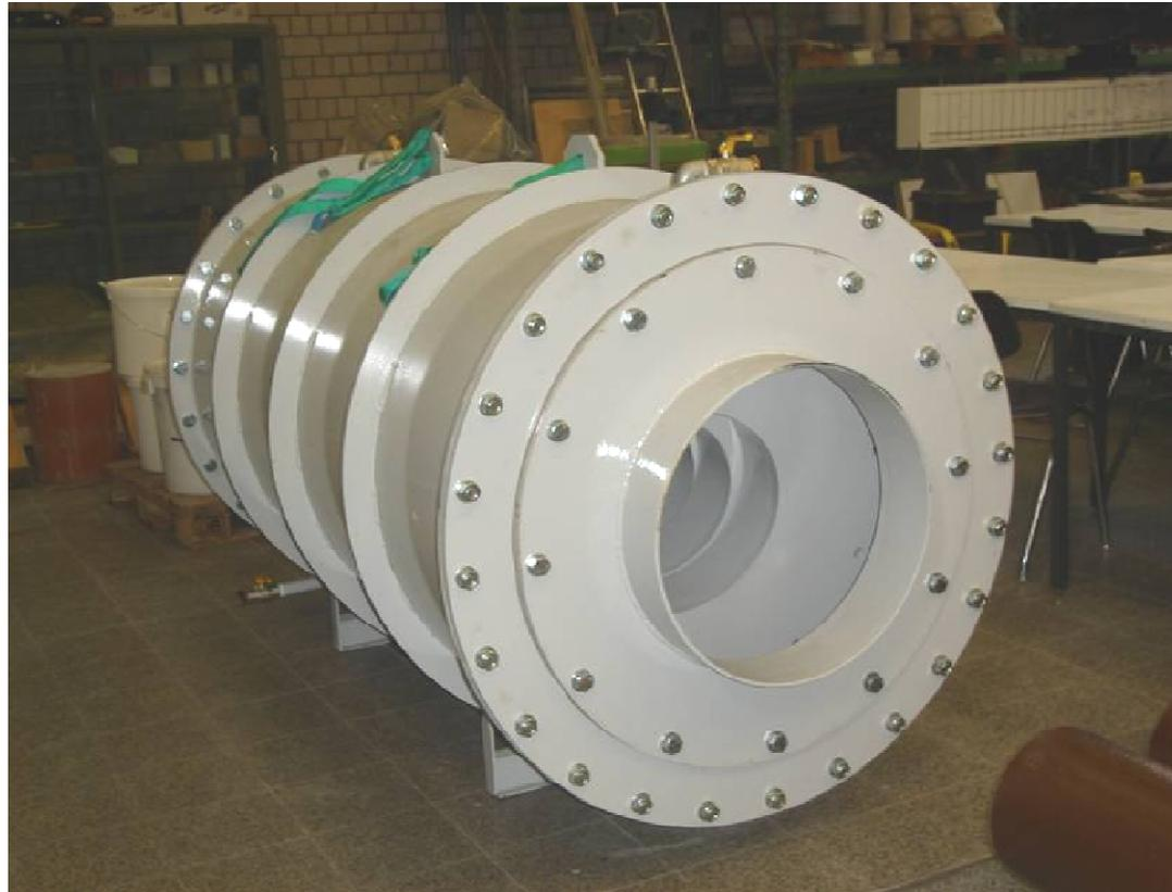
**Projekt 3: b) Druckkammer zur Prüfung von Quick-Lock-Manschetten für Altrohrzustand II (Labor für Baustoffe, August 2007)**
