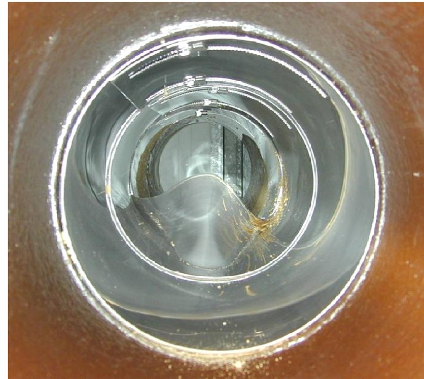
**Projekt 3: Quick-Lock-Manschetten zur Sanierung eines gerissenen Steinzeugrohres DN 300 (Altrohrzustand II) in der Druckkammer,
